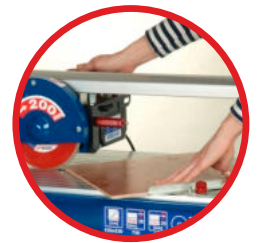
Maksymalne wymiary ciętego materiału 530 x 530 mm
